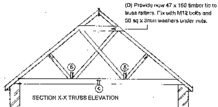
SECTION X-X TRUSS ELEVATION
